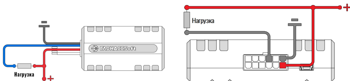
Рисунок 2.17 Подключение маломощной нагрузки (310 – слева; 312 – справа)
