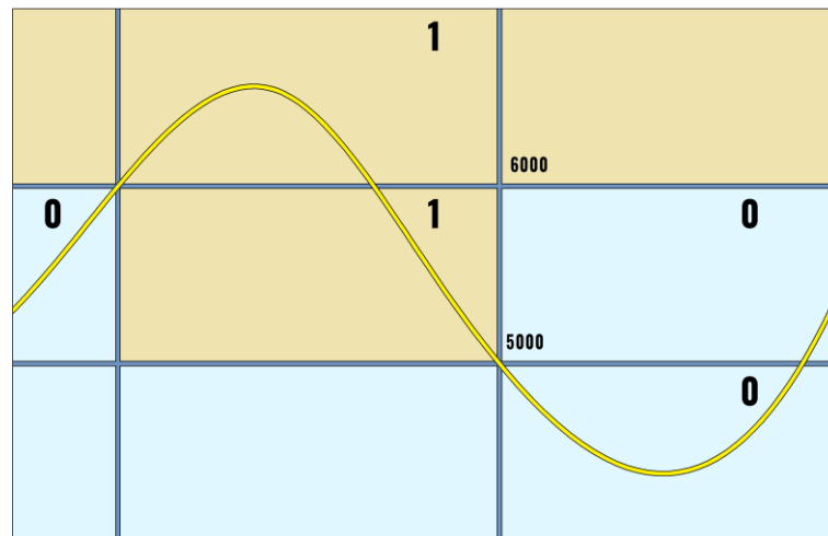
Рисунок 2.14 Преобразование аналогового сигнала в дискретный
